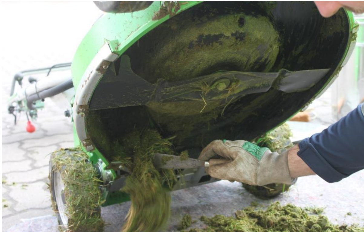
Reinigung der Mähglocke mit dem Spachtel
