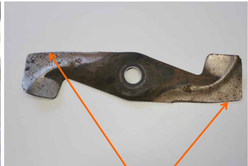
Messerbalken mit Beschädigungen
