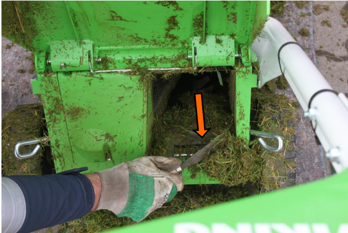
Reinigung des Auswurfschachtes mit dem Spachtel
